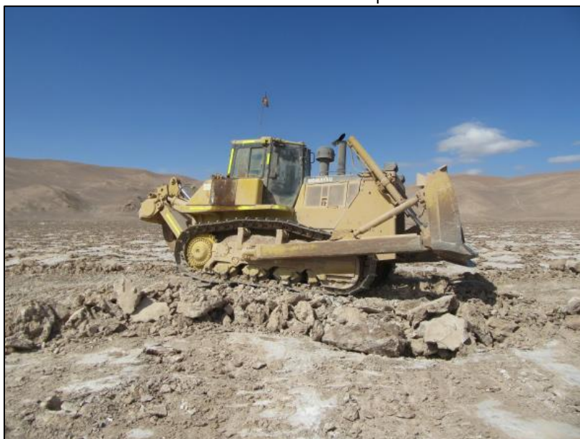
Figura 10. Camino de servicio en LAT. Bulldozer en proceso de pulverizar sedimento de la Capa V.
