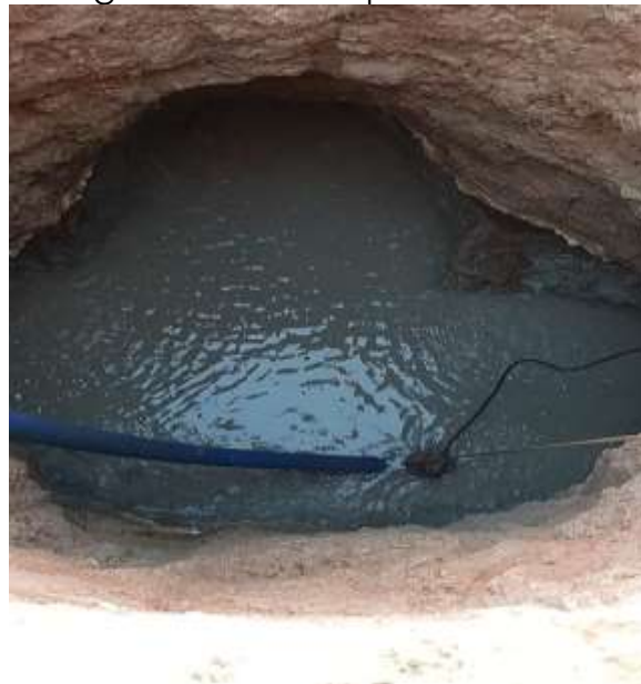
Figura 2. Perforación Torre 01. Sector LAT, Tramo 01. Perfiles de estratos sólidos y presencia de agua a 1.2 m de profundidad.
